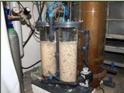
Kalkreaktor med CO 2 -tilsætning og ph-regulering
