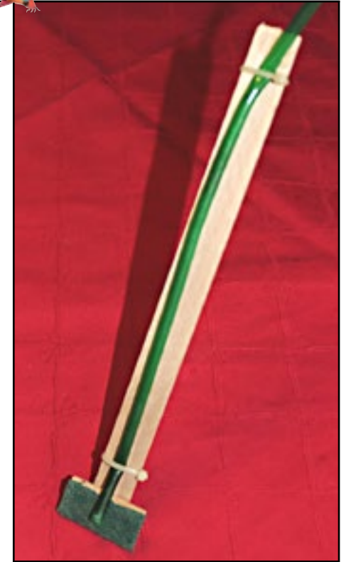
Min hjemmelavede vandstøvsuger fremstillet af en malerørrepind, et stykke luftslange, en filterstrimmel og to små plastikstrips. Foto: PP
